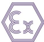
**2 Appareil ou système de protection destiné à être utilisé en atmosphères explosibles**
